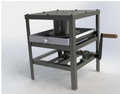
Gambar 3. Alat Pengiris Pempek Menjadi Kemplang
