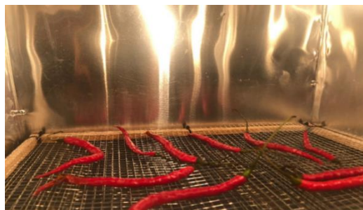
Gambar 6. Pengeringan Metode Lampu Pijar Bahan Cabai Keriting
