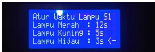
Gambar 2. Pengujian Pengiriman Data Delay Menggunakan Keypad
