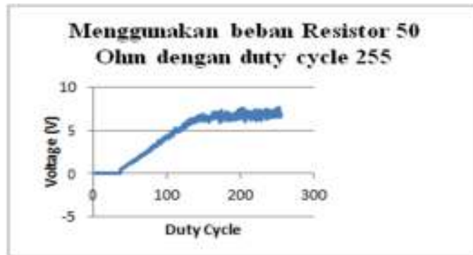
Gambar 4. Grafik pengujian algoritma menggunakan beban resistor 50 Ohm
