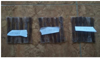
Gambar 2 (a) Anyaman serat resam, (b) Proses pembuatan sample, (c) Hasil spesimen pengujian tarik dan impact
