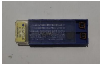
Gambar 2. Insert Carbide SUMITOMO ELEKTRIC CNMG 090308N-UX
