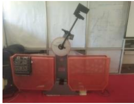
Gambar 3. Alat uji impact jb 300 b
