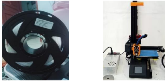
Gambar 3. Mesin 3D printing FDM REXYZ A1 dan Filamen PETG
