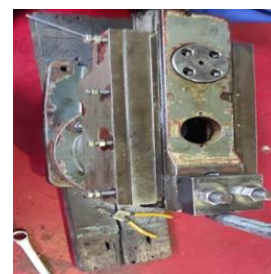
(b) Slotting Attachment yang rusak
