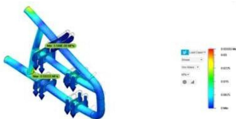
Gambar 4. Simulasi Pembebanan Pada Rangka
