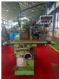
Gambar 1. Mesin Frais Lagun
