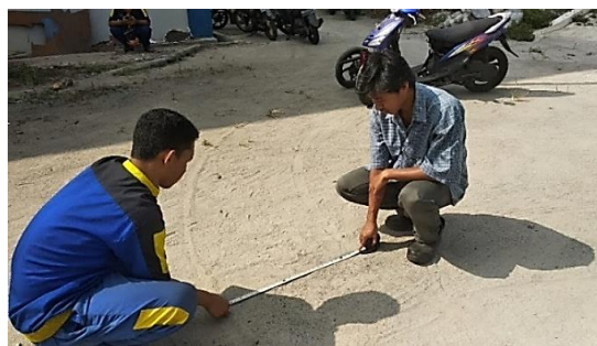
Gambar 11. Mengukur Radius Belok Menggunakan Meteran
