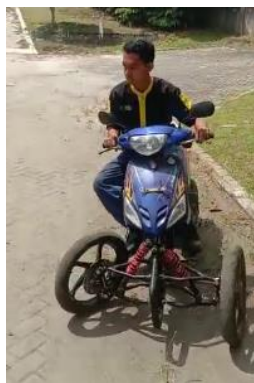
Gambar 10. Uji Belok Beban 60kg
