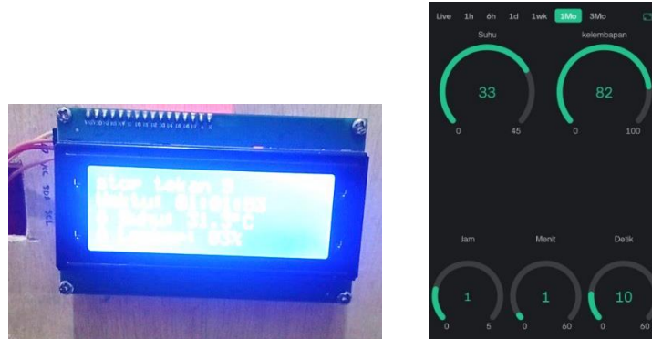
Gambar 4. Tampilan Keseluruhan Pada Saat Pengujian Pada LCD dan Blynk
