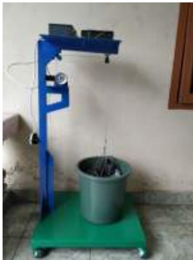
Gambar 3. Konstruksi Alat Ukur Kadar Pati Ubi Kayu
