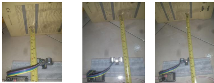
Gambar 4. Proses Pengujian Sensor Ultrasonik
