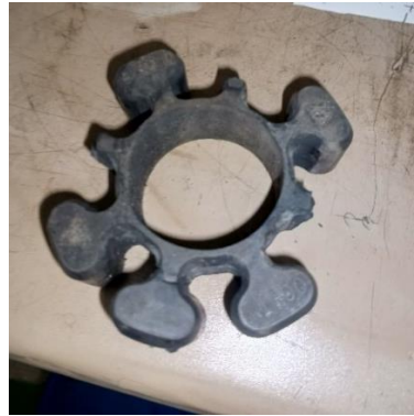
Gambar 2. Karet Coupling yang Rusak
