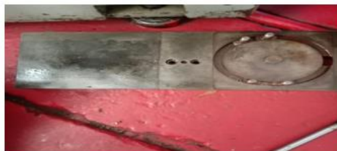
Gambar 4.4 Proses Perbaikan Eretan melintang
