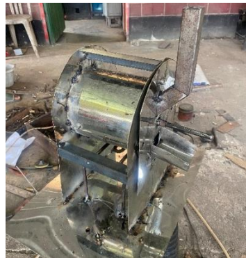
Gambar 5. Hasil Alat Mesin Sangrai Kopi
