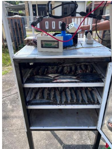
Gambar 9. Uji Coba Pengeringan Ikan Dencis
