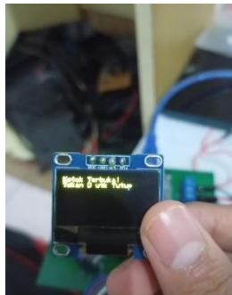
Gambar 6. Hasil Pengujian Keypad Matrix 4x4 Pin Input Benar
