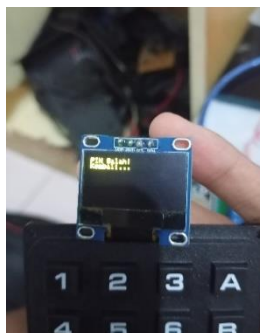
Gambar 7. Hasil Pengujian Ke-2,3,4,Dan 5 Keypad Matrix 4x4 Input Pin Salah
