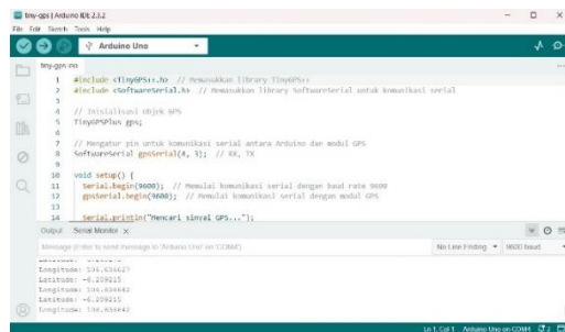
Gambar 4. Program Modul GPS NEO-6M V2
