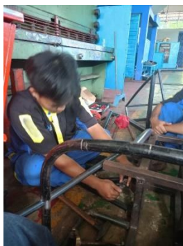
Gambar 2. Proses Pembuatan Rangka Depan Mobil Listrik
