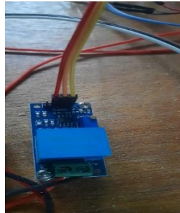
Gambar 10. Wiring Sensor Tegangan
