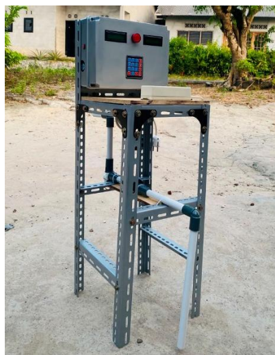
Gambar 2. Kontruksi Alat Sistem Monitoring Konsumsi Air dan Listrik
