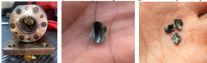
Gambar 2. Kondisi ball retainer (deflektor) setelah pembongkaran
