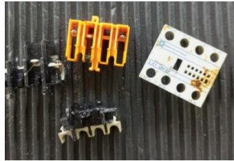
Gambar 2. Kontaktor bantu getas (rapuh)
