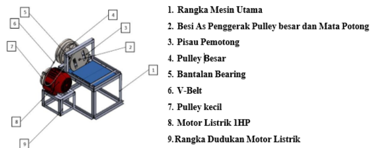
Gambar 3.1 Modifikasi Mesin Pemotong Keripik
