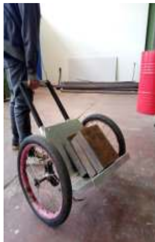
Gambar 4. Uji beban pada Troli
